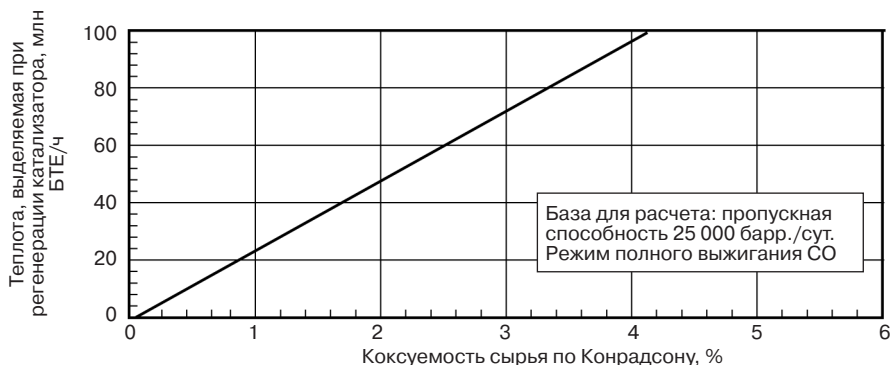
Рис. 3.1.14. Влияние коксуемости сырья по Конрадсону на скорость теплоотдачи при регенерации катализатора (1 БТЕ = 0,252 ккал)
