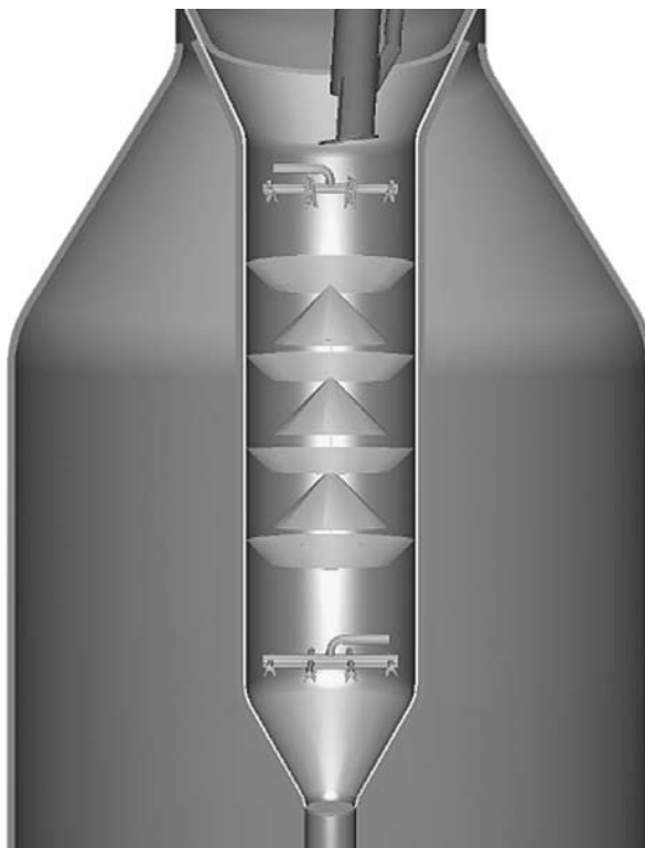
Рис. 3.1.7. Секция отпарки отработанного катализатора
