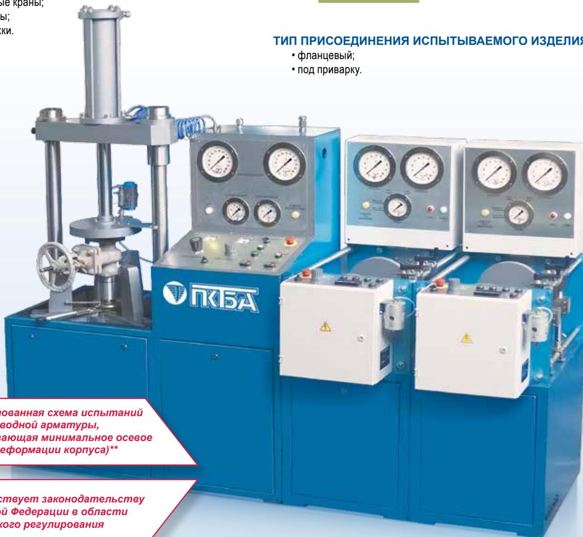
*Запатентованная схема испытаний трубопроводной арматуры, обеспечивающая минимальное осевое сжатие (деформации корпуса)\*\**
