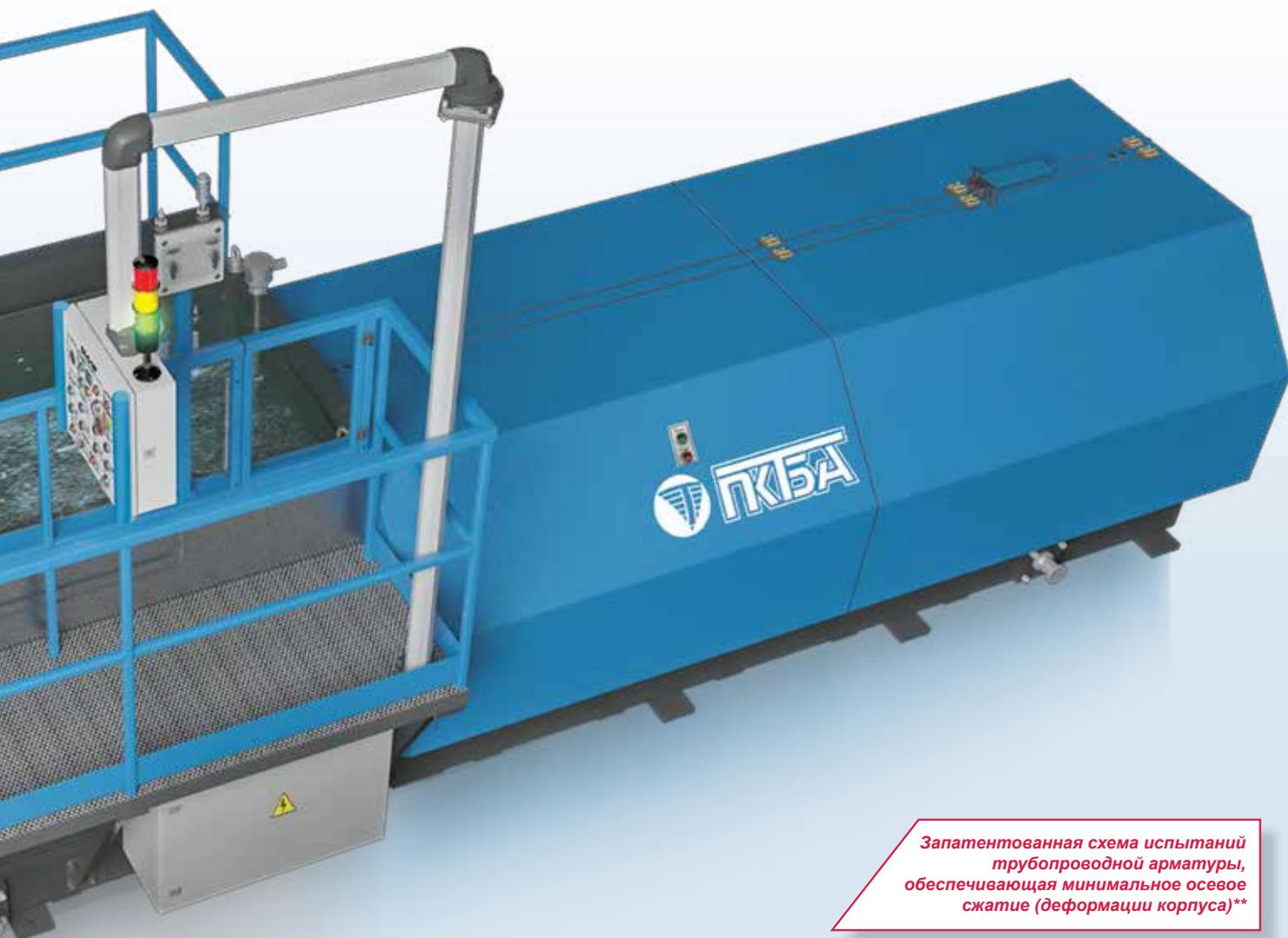
*Запатентованная схема испытаний трубопроводной арматуры, обеспечивающая минимальное осевое сжатие (деформации корпуса)\*\**
