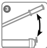
Произведите 3-5 качков рукояткой/педалью, плотно закрутите винт для стравливания воздуха и проверьте помпу в работе. При необходимости повторите порядок действий.
