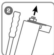
Установите помпу под углом 30° заливной пробкой вверх и открутите ее.
