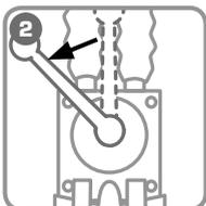
Для подачи давления на инструмент №1 установите распределитель в крайнее левое положение
