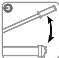
Нагнетайте давление до завершения операции (при опрессовке - смыкание матриц, при резке - полное перерезание кабеля)
