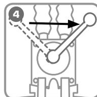
После завершения рабочего цикла поверните распределитель в крайнее правое положение. При этом давление в исполняющем инструменте полностью сбросится.
