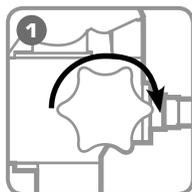
Поверните дроссельный винт в положение «Закреть»
