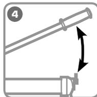
**4** Нагнетайте давление рукояткой/педалью до завершения операции (при опрессовке - смыкание матриц, при резке - полное перерезание кабеля или до срабатывания АСД)
