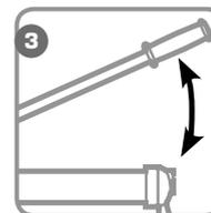
Произведите 3-5 качков рукояткой, плотно закрутите заливную пробку и проверьте помпу в работе. При необходимости повторите порядок действий.
