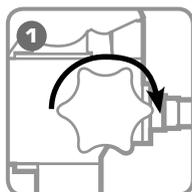
Поверните дроссельный винт в положение «Закреть»
