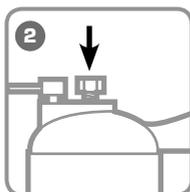
Установите помпу под углом 30° заливной пробкой вверх и открутите винт для стравливания воздуха. Для помпы ПМН-7012 произвести установку педали в рабочее положение.
