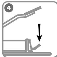
После завершения рабочего цикла сбросьте давление, нажав на «ножной рычаг принудительного сброса давления»
