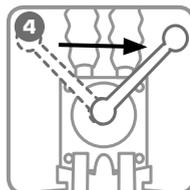
После завершения рабочего цикла поверните распределитель в крайнее правое положение. При этом давление в исполняющем инструменте №1 полностью сбросится.
